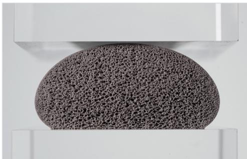
Die unverpresste Polyurethan-Schaumdichtung auf ebener Auftragsfläche vor dem Einbau
