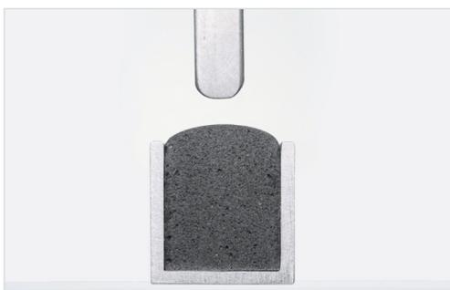
Die unverpresste Polyurethan-Schaumdichtung in der Bauteilnut vor dem Einbau
