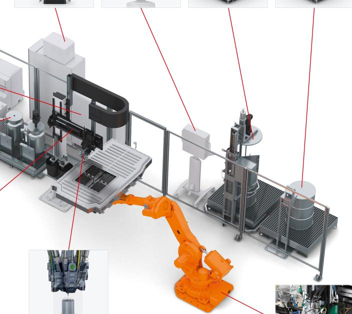
Der sensorgesteuerte 2-/3-Komponenten **Präzisionsmischkopf MK 800** mit Hochdruckwasserspülung und dynamischer Vermischung
