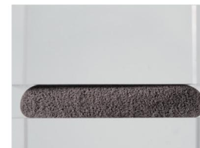
Querschnitt Polyurethanschäumraupe zu 50 % verpresst
