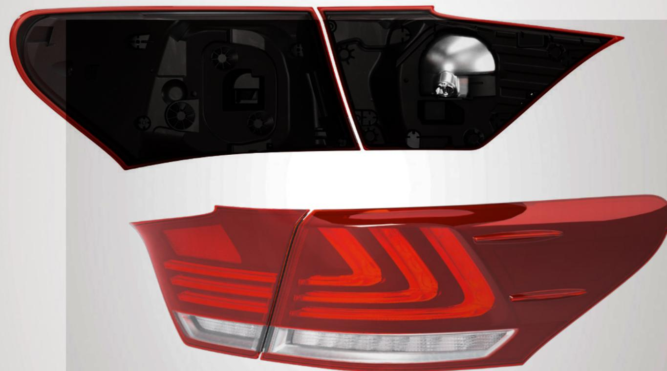
Rückleuchte mit umlaufender Polyurethanschäumdichtung
