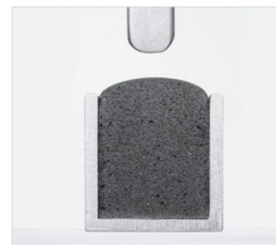
Querschnitt Polyurethanschäumraupe in Nut unverpresst
