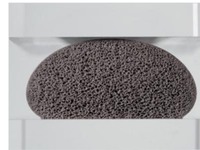
Querschnitt Polyurethanschäumraupe unverpresst
