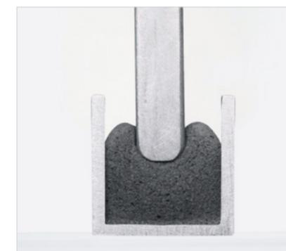
Querschnitt Polyurethanschäumraupe in Nut zu ca. 50 % verpresst
