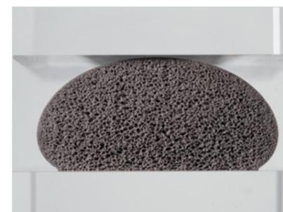
Querschnitt Polyurethanschäumraupe unverpresst
