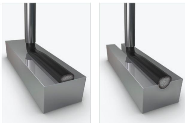
Thixotrope Dichtung 2D ohne Nut
