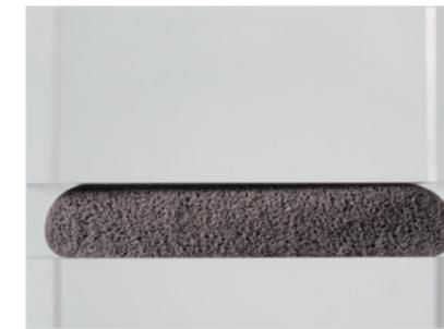
Querschnitt Polyurethanschäumraupe zu 50 % verpresst
