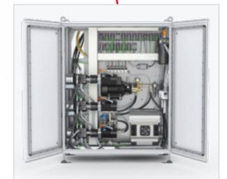
Der **Dosiermaschinenchrank** beinhaltet die Komponenten der Dosierperipherie wie z. B. die Dosierpumpen.
