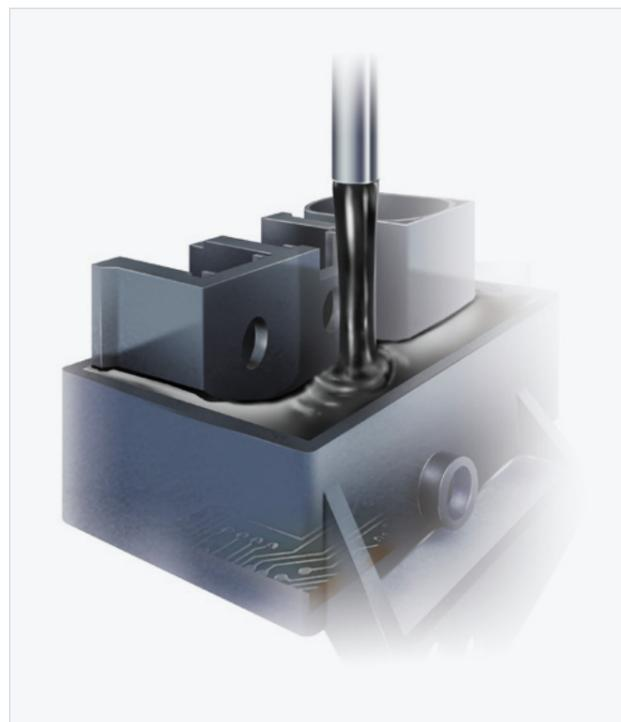
Dosiereintrag von Polyurethanverguss in das Bauteil über den CNC-gesteuerten Mischkopf der Dosieranlage DM 502
