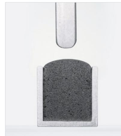
Querschnitt Polyurethanschaumraupe in Nut unverpresst
