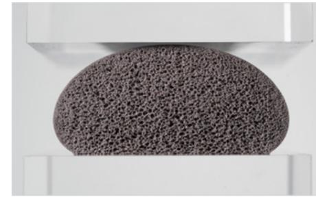
Die unverpresste Polyurethan-Schaumdichtung vor dem Einbau.
