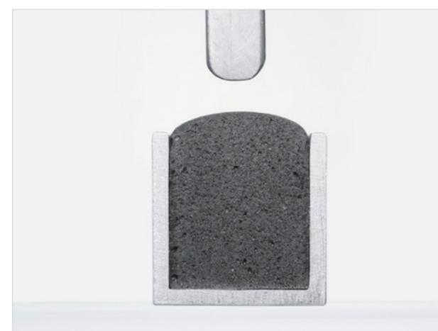
Darstellung der Dichtung im geöffneten Zustand der Straßenlampe, die Dichtung ist unkomprimiert
