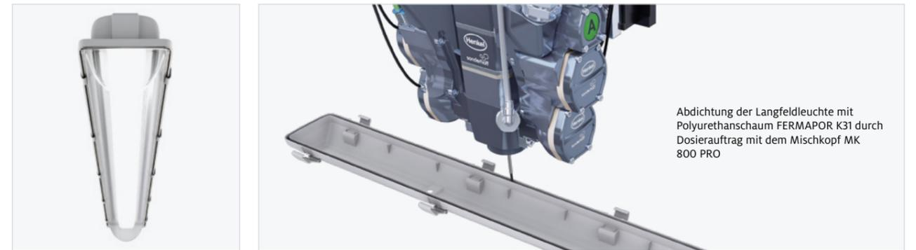
Abdichtung der Langfeldleuchte mit Polyurethanschaum FERMAPOR K31 durch Dosierauftrag mit dem Mischkopf MK 800 PRO
