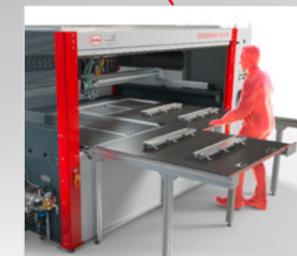
In der Standardausführung sichert ein **manuelles Hubtor** den Bereich zwischen Dosierauftrag und Einlegevorgang. Auf Wunsch kann eine alternative Variante mit Schnelllaufsystem angeboten werden.
