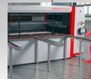
Die manuelle **Hubtür** bzw. das optional bestellbare **Schnellaufitor** grenzen den Verfahrbereich des Linearroboters zum Bediener sicher ab.
