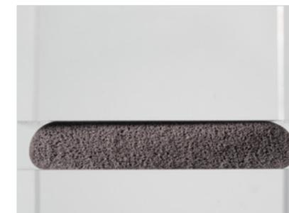
Querschnitt Polyurethanschäumraupe zu 50 % verspreßt
