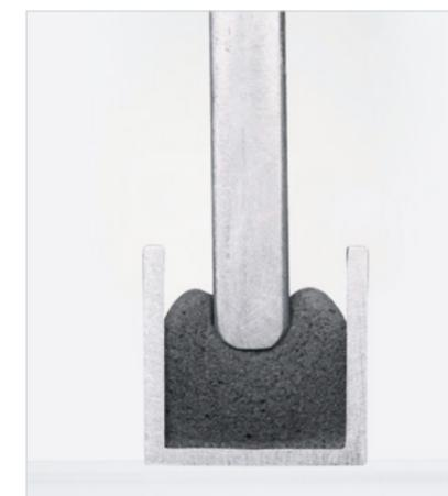
Querschnitt Polyurethanschaumraupe in Nut zu ca. 50 % verpresst
