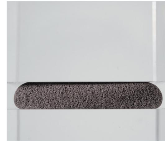
Querschnitt Polyurethanschaumraupe zu 50 % verpresst
