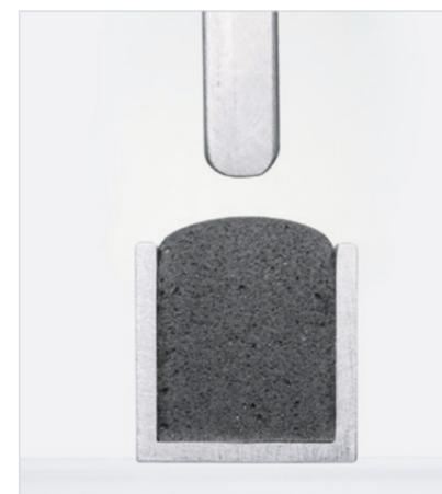
Querschnitt Polyurethanschaumraupe in Nut unverpresst
