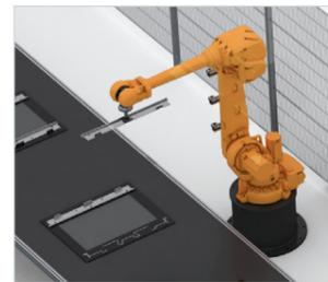
Der **6-Achs-Roboter** fügt die Metallhalterungen zur Befestigung eines Halterahmens auf die Innenseite der Ofenglastür
