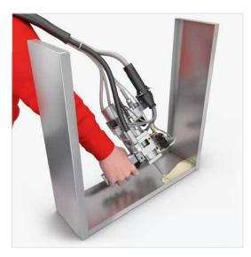
Manueller Auftrag von Klebdichtstoff mit dem Mischkopf MK 50
