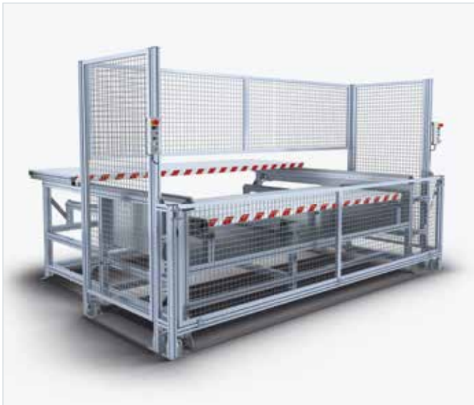
Wechseltisch WT 2-Level: Zwei Aufnahmeplatten im Pendelbetrieb übereinander in zwei Ebenen
