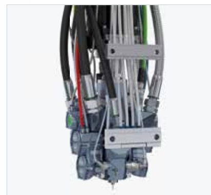
Rückseitige Ansicht auf Anbauhalterung und Ventilinsel
