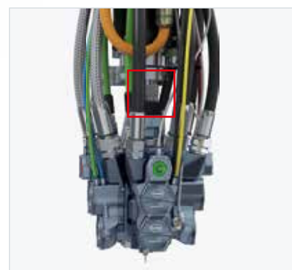
Einstellrad zur Hubverstellung des Düsenverschlusssystems (DVS 3)
